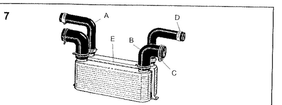
Med värmexlaren i kombination med Aldes centralvärmesystem, utnyttjas bilmotorns värmesystem för uppvärmning av husbilen. Värmexlaren kan även användas i omvänd riktning, och fungerar då som motorvärmare. En separat cirkulationspump (I) bör då monteras.
